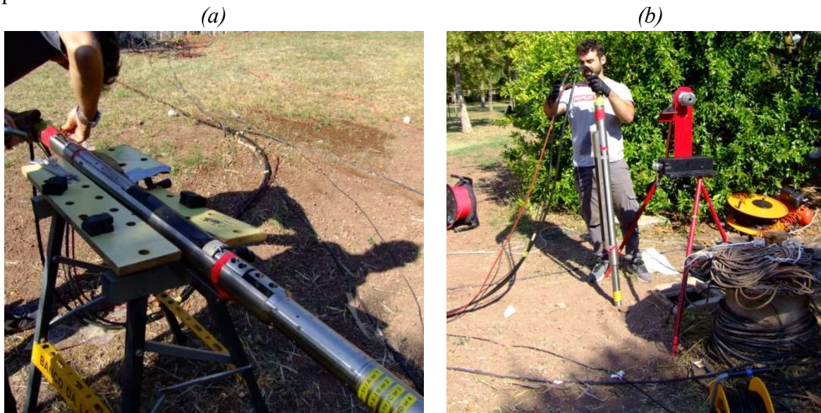
Figura 2: a) Assemblaggio della Sonda sparker SH-66 per la generazione di onde SH. b) Procedura di orientamento precedente alla calata in foro
